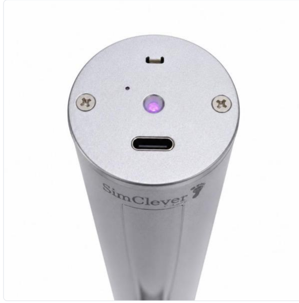
Cihaz gövdesinin üst görünümü: kontrol butonu, durum LED'i (mor sabit — hazır durumu) ve USB Type-C şarj girişi.
